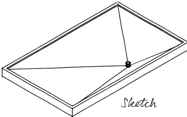
Die Geometrie der Balkonplatte kann sowohl über Parameter als auch über Griffe verändert werden. Die Gefälle sind in ihrer Neigung modifizierbar und werden sofort aktualisiert. Der Abfluss ist ebenfalls mit einem Griff versehen, so dass er an beliebiger Lage positioniert werden kann. Diverse Einbauteile wie Transportanker werden automatisch an die sich permanent ändernden Höhenkoten der Oberfläche angepasst. Diese Einbauteile werden in Abhängigkeit des Elementschwerpunktes positioniert.
